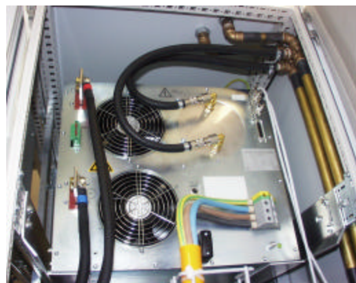
32 kW Netzgerät mit Option Liquid Cooling
