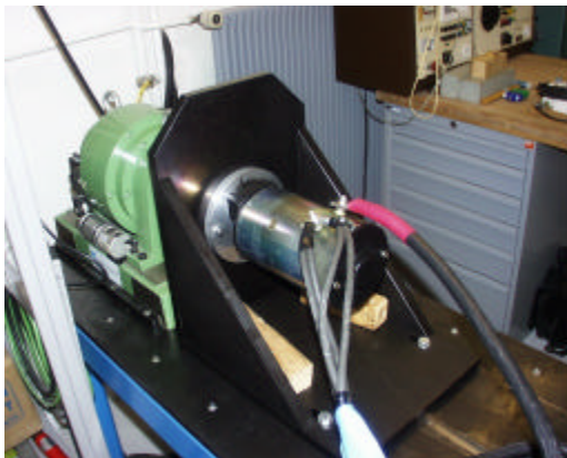
DC-Motor (Prüfling) an Wirbelstrombremse
