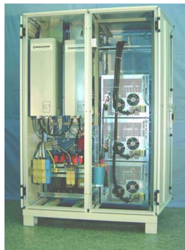
Front- und Rückseite einer bidirektionalen Stromversorgung mit Netzspeisung
