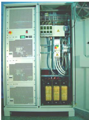
Front- und Rückseite einer bidirektionalen Stromversorgung mit Netzspeisung
