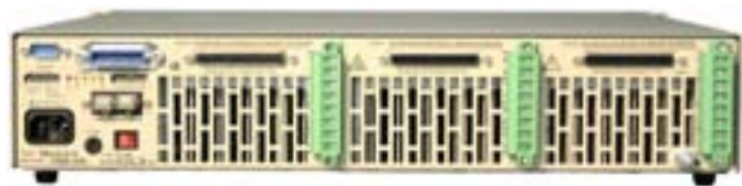
Bild 2 (Rückseite): Die Prüflinge werden über steckbare Klemmleisten an der Rückseite angeschlossen.
