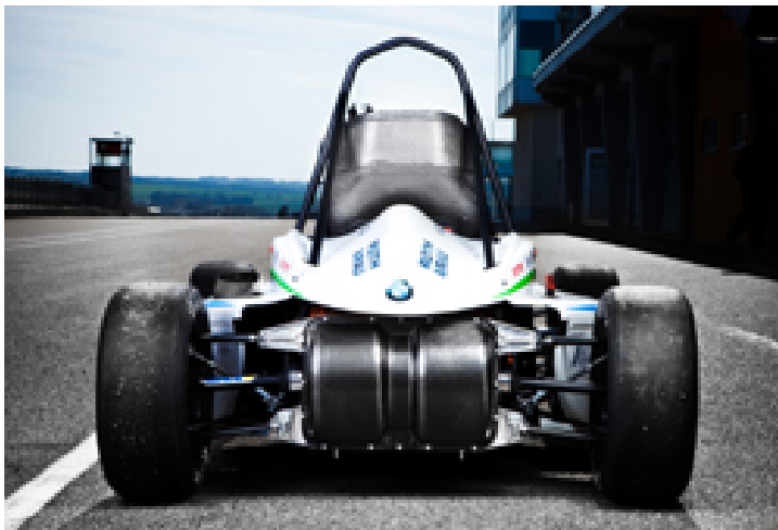
Bild 2: Geballte Elektro-Power: 2x 30kW an den Hinterrädern
