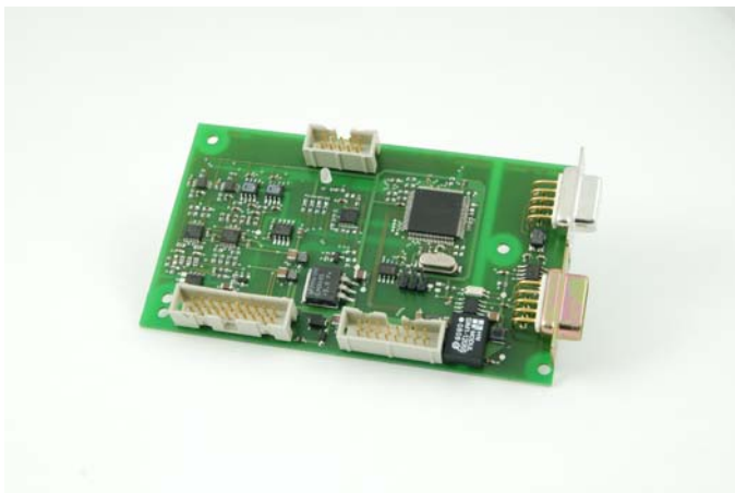
Bild S045: SupplyCom kann für den Betrieb mit beliebigen Konstantern parametrierbar werden. Die Befestigung erfolgt auf der DIN-Schiene.
