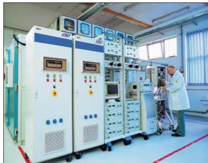
Blick 2: Blick in das Prüflabor der SMA Technologie AG, in dem auch Wechselrichter mit dem PV-Simulator getestet werden
