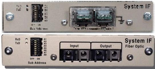
Die vom Steuerrechner per Dateninterface ankommenden Daten werden im Interface auf das Format des Systembusses umgeformt und seriell durch alle Geräte geschickt.
