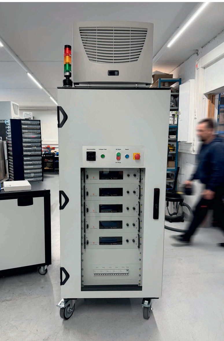
1.500 V und 150 A in einem Racksystem mit 4-kW-Dach-Luft-Wasser-Wärmetauscher. © Schulz-Electronic GmbH
